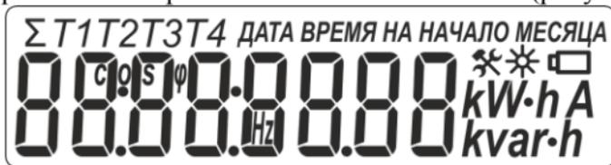
Рисунок 3.1 – Режим теста ЖКИ счетчика
